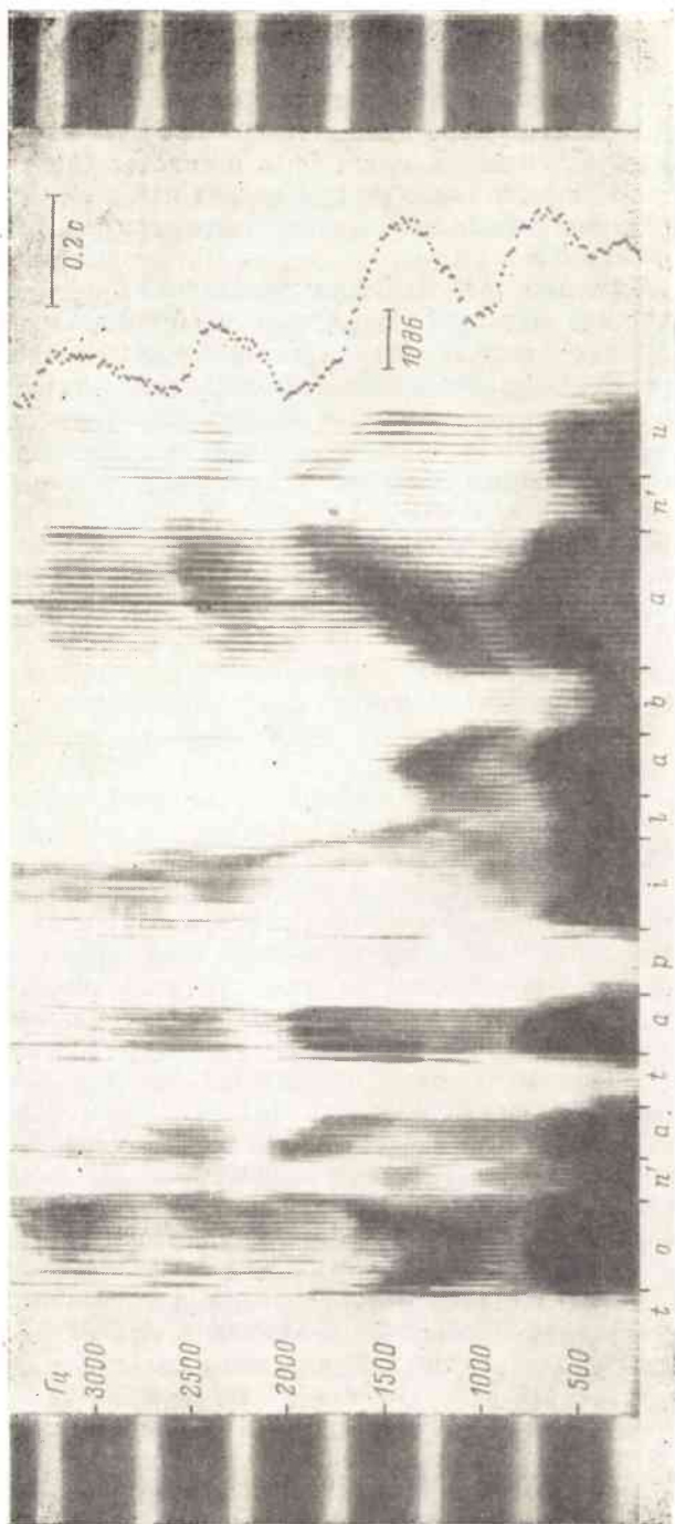
Рис. 1.9. Динамическая спектрограмма фразы Тоня пошла баню. Обозначения см. в тексте.
