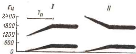
Рис. 12.21. Схема синтеза стимулов, использованных при исследовании восприятия скорости изменения частоты формант. По [352].
